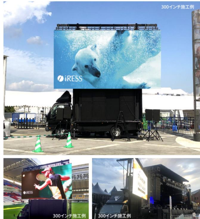
**MAX 300インチの大型LEDビジョンを画面下3mの高さにセット**
